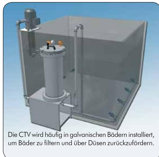
Die CTV wird häufig in galvanischen Bädern installiert, um Bäder zu filtern und über Düsen zurückzuführen.
